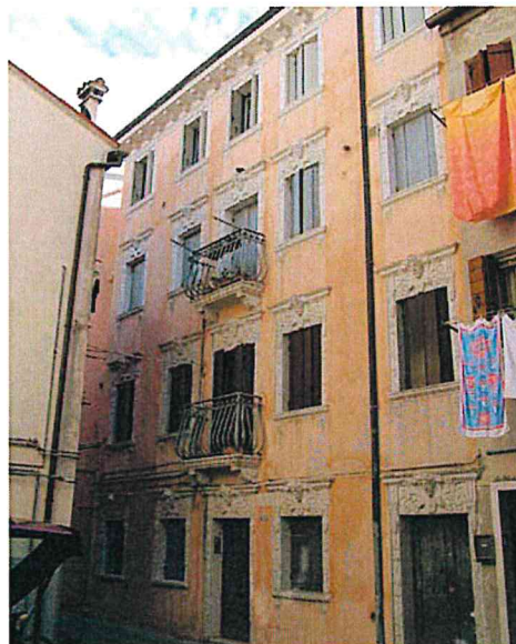
Chioggia - Edifici novecenteschi a quattro piani con numerosi elementi di finitura sulla facciata realizzati in "pietra artificiale"
