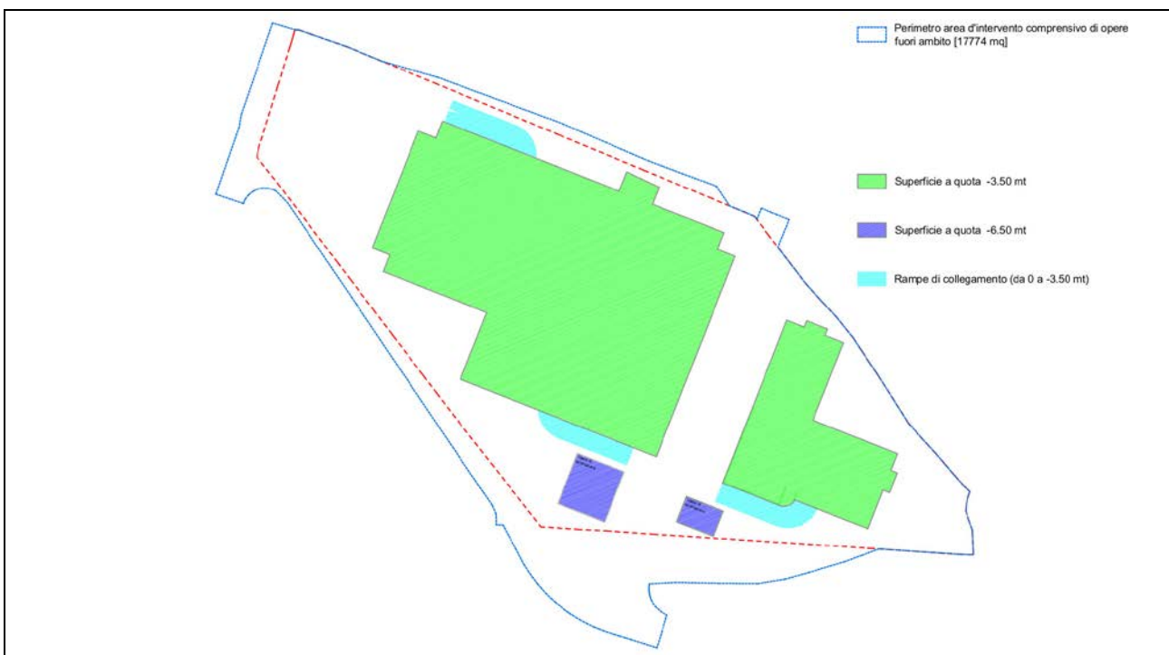
Fig. 5 - Planimetria degli interrati, in verde -3,50 m, in blu -6,50 m, in azzurro le rampe di collegamento.
