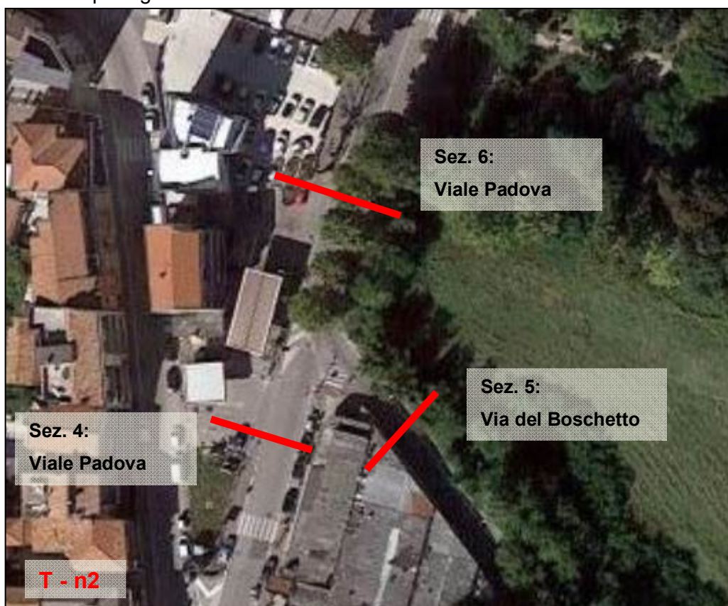
Immagine. Intersezione a T tra Viale Padova e Via del Boschetto. Definizione dei rami per la lettura delle matrici Origine/Destinazione
