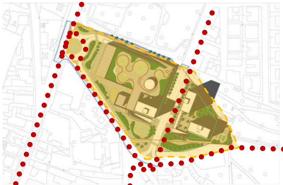
Figura 6. Planimetria, evidenziati in giallo il perimetro di pertinenza caso studio, in rosso la rete viaria cambiata in base al progetto 1,
